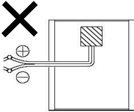
太陽電池モジュール裏面およびケーブル接続部は触らないようにしてください。
